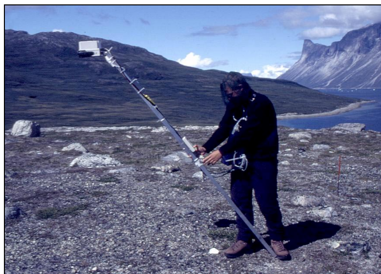
Figur C.4 Måling af reflektion med Cropscan Multi Spectral Radiometer 16 over afblæsningsflade ved Itinnera i Nuukområdet (Foto: K.G. Motzfeldt).
