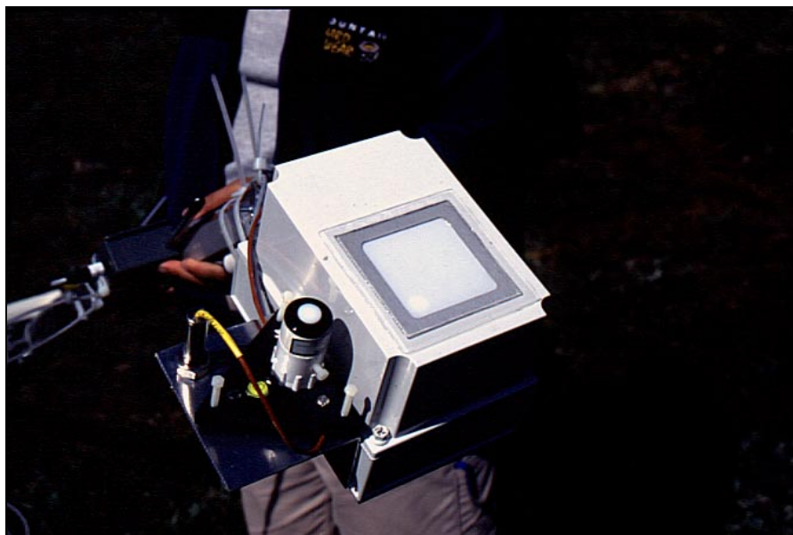
Figur C.5 Cropscan Multispectral Scanner 16 i vandtæt hus. Det hvide glas indenfor metalrammen er en diffusor, som spreder den indkommende stråling for de opadvendte sensorer. På siden af huset kan ses en sensor for total indkommende kortbølget stråling samt en sensor for overfladetemperatur. Bag huset skimtes vindhastighedsmåleren (Foto: M.P. Tamstorf).
