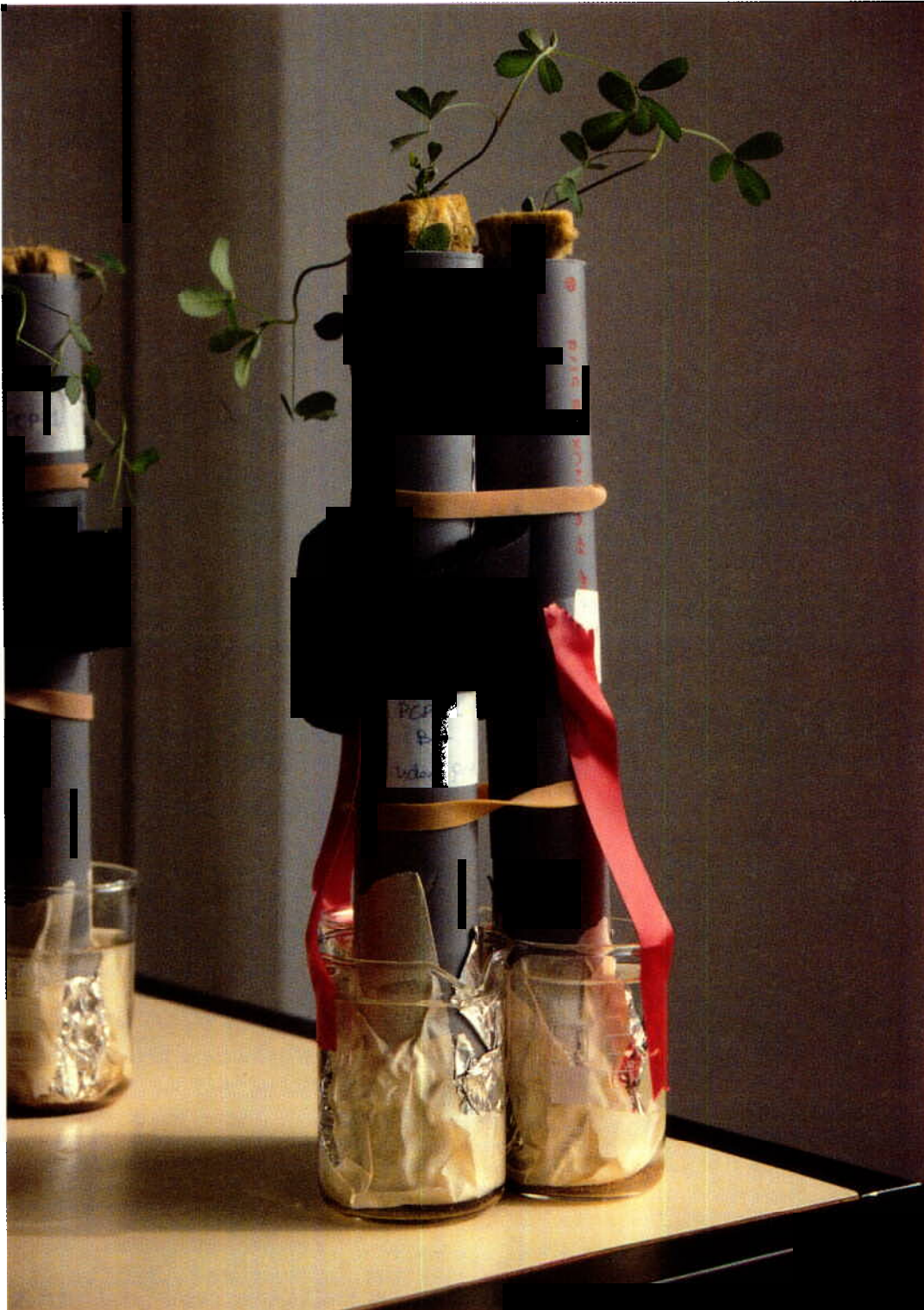
Figur 11. Forsøgsopstilling til undersøgelse af jordrensning med inokulerede plante- rødder.
