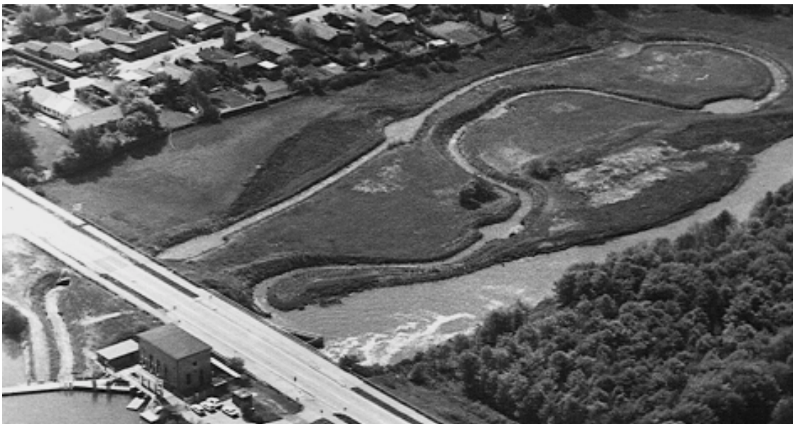
Figura 4.13. Áreas de retención de la corriente en tuberías debajo de un camino. Para asegurarles a los peces el libre paso por las tuberías, se puede elevar el nivel del agua e insertar áreas de retención de la corriente.
