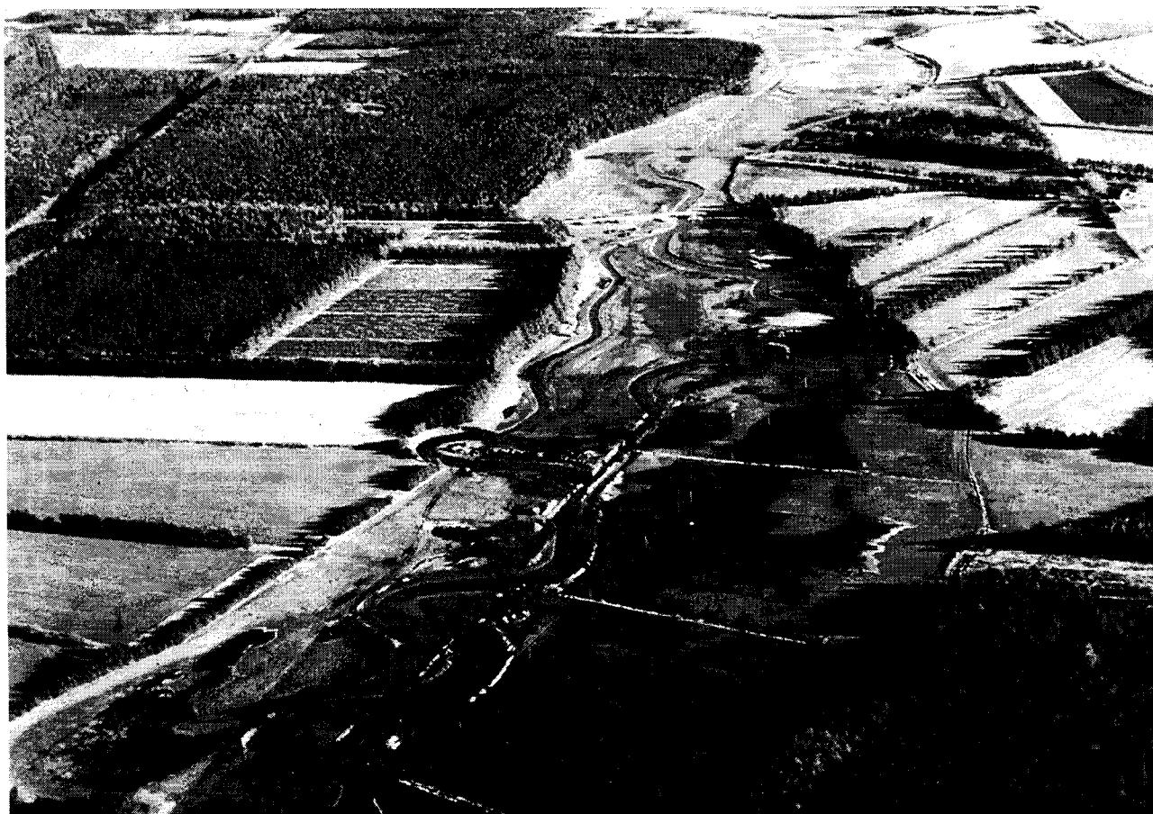
Figur 4.17. Vandstandshævning og øget oversvømmelsesfrekvens ved at genslynge vandløbet. Man kan hæve vandstanden og øge frekvensen af oversvømmelser ved at genslynge vandløbet.
