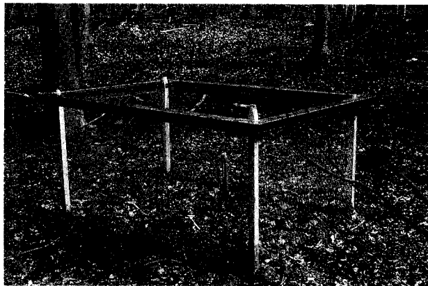
Figur 3: Fotografi af de opstillede musetætte hegn med overliggende u-bukket stålprofil. Maskestørrelsen i nettet er 6,3 x 6,3 mm, grundarealet er 0,9 x 1,5 m, højden er 0,7 m over jorden og 0,3 m under jordoverfladen.
