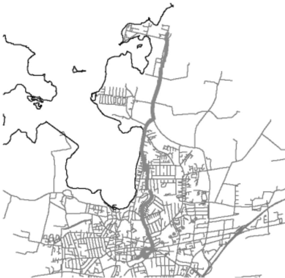
Figur 3. Eksempel på en cykeltur mellem Danmarks Miljøundersøgelser og Roskilde station registreret med GPS udstyr med en prik for hvert sjette sekund visualiseret på et digitalt vejnet
