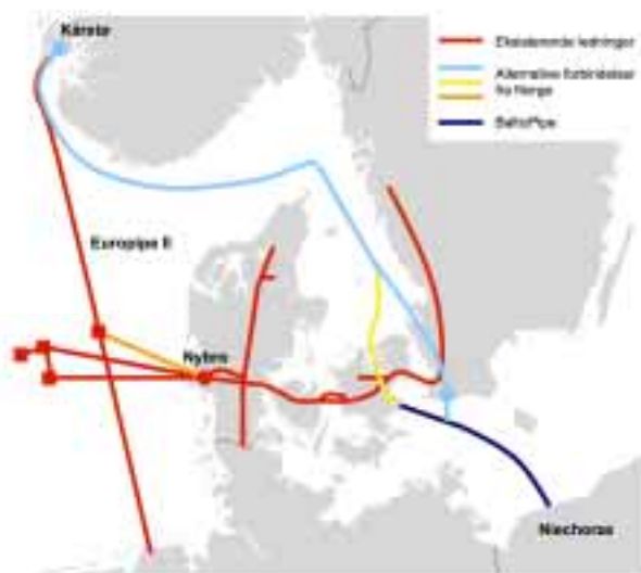
Figur 1 Forskellige muligheder for etablering af ledningsforbindelse mellem de norske naturgasfelter og Polen/Danmark.
