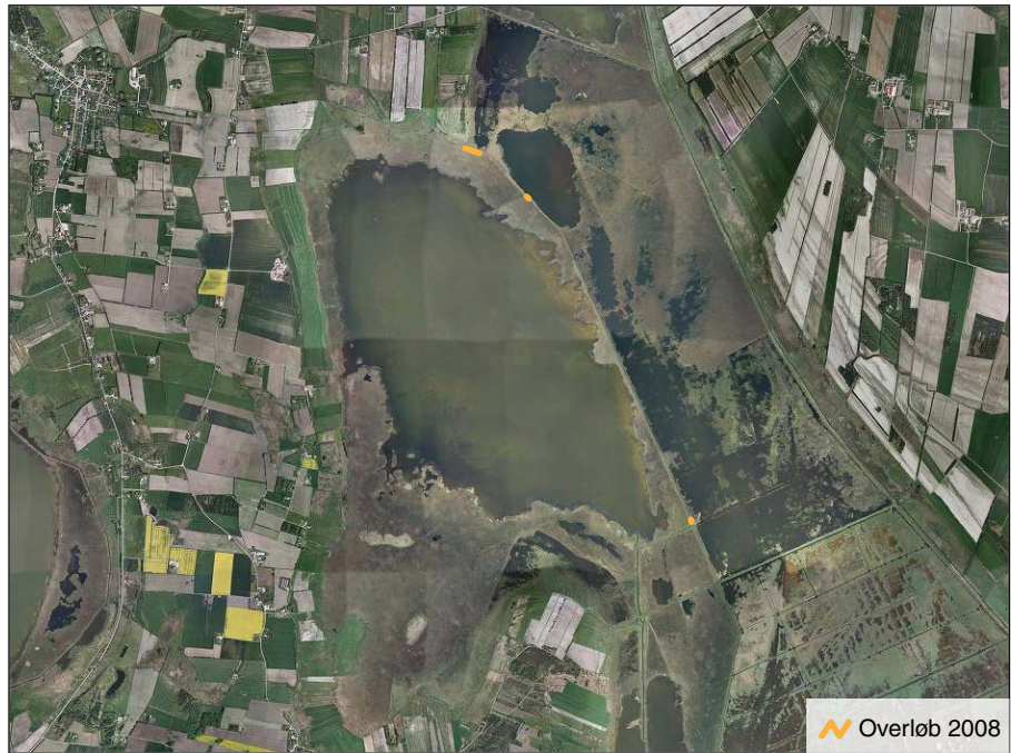
Figur 5. Kortlægning af steder på Selbjergdiget, hvor vand fra Bygholm Vejle Nord løber over ved høj vandstand, 20. april 2008 (se tekst).
