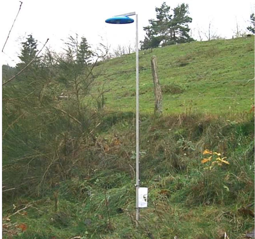
Figur 9.2 Målepinden til bestemmelse af ammoniakconcentrationer i Bisgyde i Molsbjerge.
