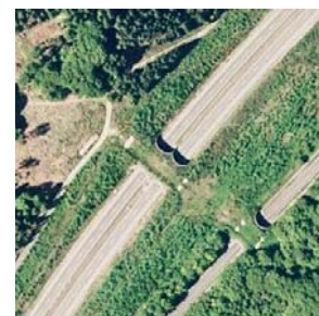
Faunapassage i Nordjylland som forbinder naturområder på begge sider af en motorvej og landevej.
