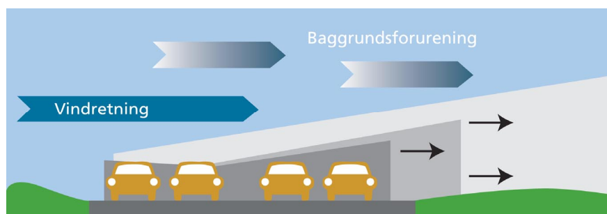
Figur 2.2 Luftforureningen fra en vej i det åbne land aftager hurtigt med afstanden pga. fortynding.
