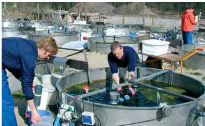
Figur 3-25 Store kar med 3.000 l vand, hvor temperaturerne blev øget med 3-5°C for at studere de forventede klimaændringers virkning på de biologiske forhold i søer.
