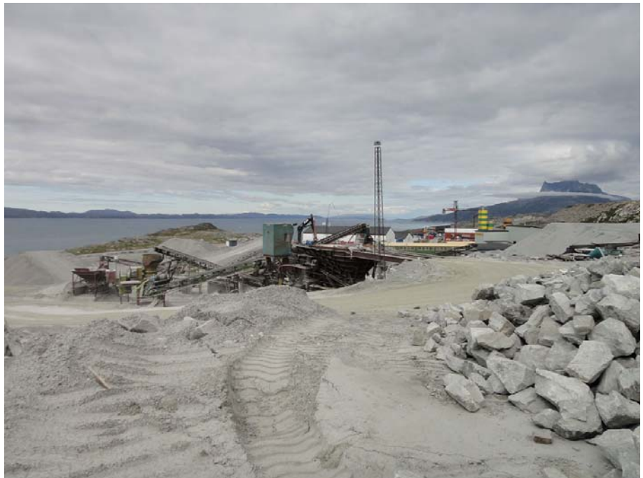
Figur 5. Knuse- og sigteanlæg ved Nuuk. Klipper/sten til knusning indsamles forskellige steder i Nuuk, bl.a. i forbindelse med anlæg og byggeri.
