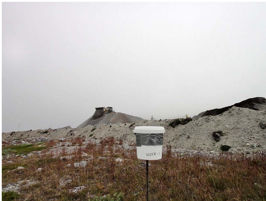
Figur 1. Støvopsamlingsbøtte her placeret ved Nuuk Betoncentral august-september 2011.
