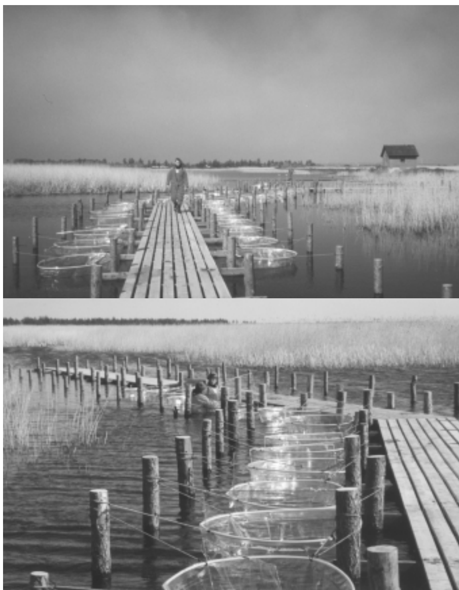
Foto. Forsøgsopstillingen i Kogleakssøen 1999. Hver af de i alt 48 bassiner indeholdt 600-800 l vand og var forankret i bunden med en metalring, således at der var fri kontakt mellem sediment og vand. I 2000 var bassinerne etableret i en flydende opstilling i forskellig højde over bunden.
