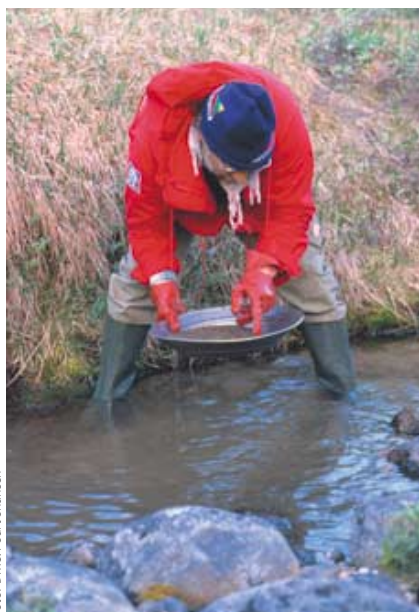
Mineselskabet brugte også den "gode gamle" guldgravermetode til at skylle guldet fri af sedimentet.
