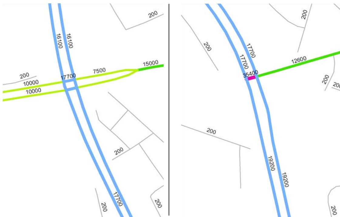
Figur 4.1 Eksempler på fejl ved små vejsegmenter mellem dobbeltdigitaliserede veje
