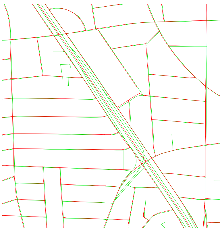
Figur 4 Motorvejene er mere detaljerede i Top10DK end i kommunernes vejnet
