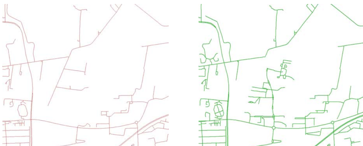
Figur 1.2 Større forskelle mellem TOP10DK (ældre version, rød, venstre) og KORT10 (nyere version, grøn, højre) i nyt byudviklingsområde i Trekroner i den østlige del af Roskilde.
